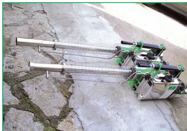
Fot. 2, 3. Porównanie zamgławiaczy termicznych przeznaczonych do: aplikacji preparatów rozpuszczalnych w olejach (prosta końcówka rury zamgławiacza); aplikacji preparatów rozpuszczalnych w wodzie (końcówka rury zamgławiacza jest kielichowato wygięta)
