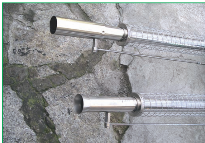
Fot. 2, 3. Porównanie zamgławiaczy termicznych przeznaczonych do: aplikacji preparatów rozpuszczalnych w olejach (prosta końcówka rury zamgławiacza); aplikacji preparatów rozpuszczalnych w wodzie (końcówka rury zamgławiacza jest kielichowato wygięta)
